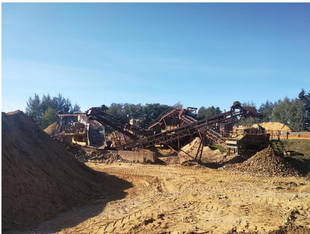
**Рисунок 3 – Стационарный дробильно-сортировочный комплекс на АББ «Погулянка»**
